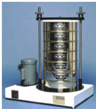
Recommandée pour les applications sur produits plus grossiers, la tamiseuse économique RX-812 "Coarse" a la capacité unique d'accepter les tamis analytiques de 8" ou de 12" grâce à un adaptateur fournis.
